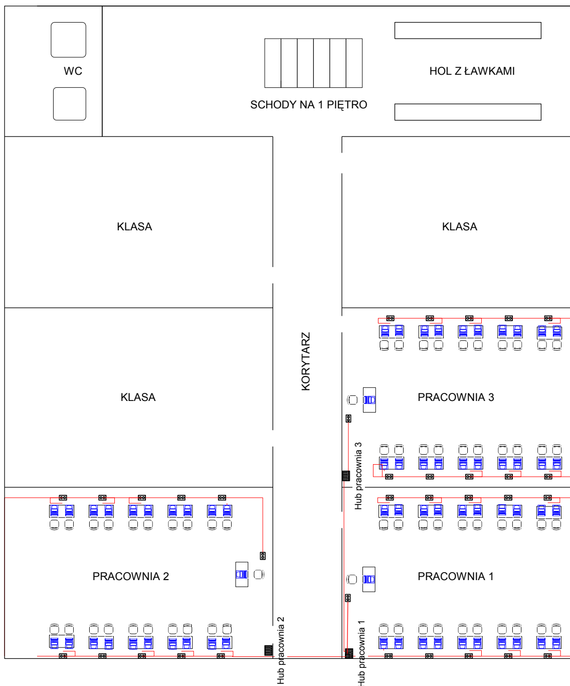
rys.14 przebieg traktów kablowych w budynku dydaktycznym 2 piętro
