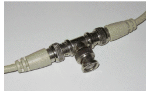
Trójniki (rozgałęźniki ) do podłączania komputerów (ang. T-connector)
