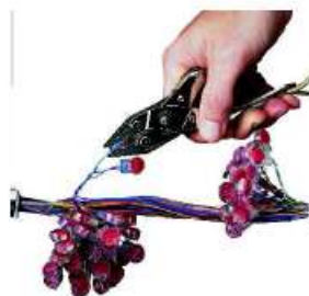
złącze wykonane z użyciem łączników pojedynczych
