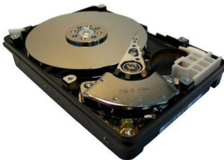
Rys2. Dysk twardy po zdjęciu pokrywy
